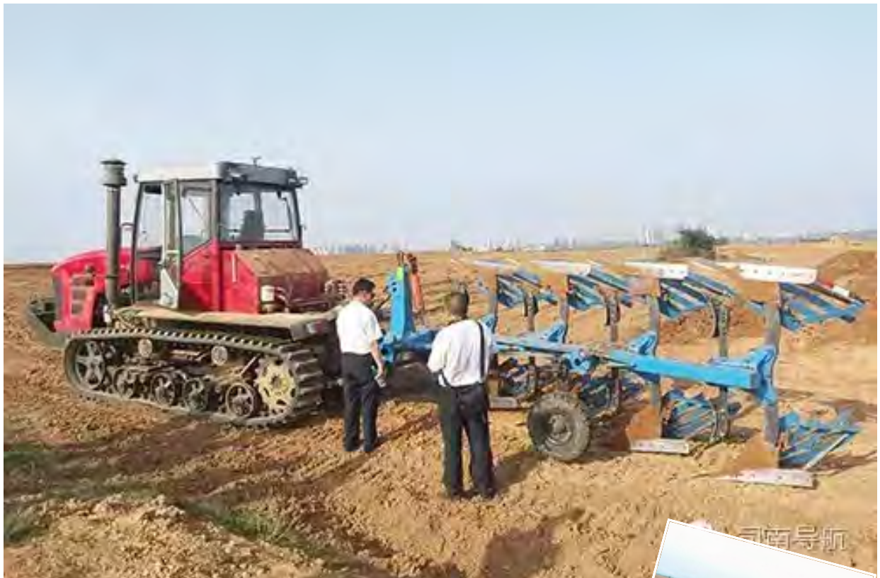
前装自动驾驶履带式拖拉机安装测试现场
