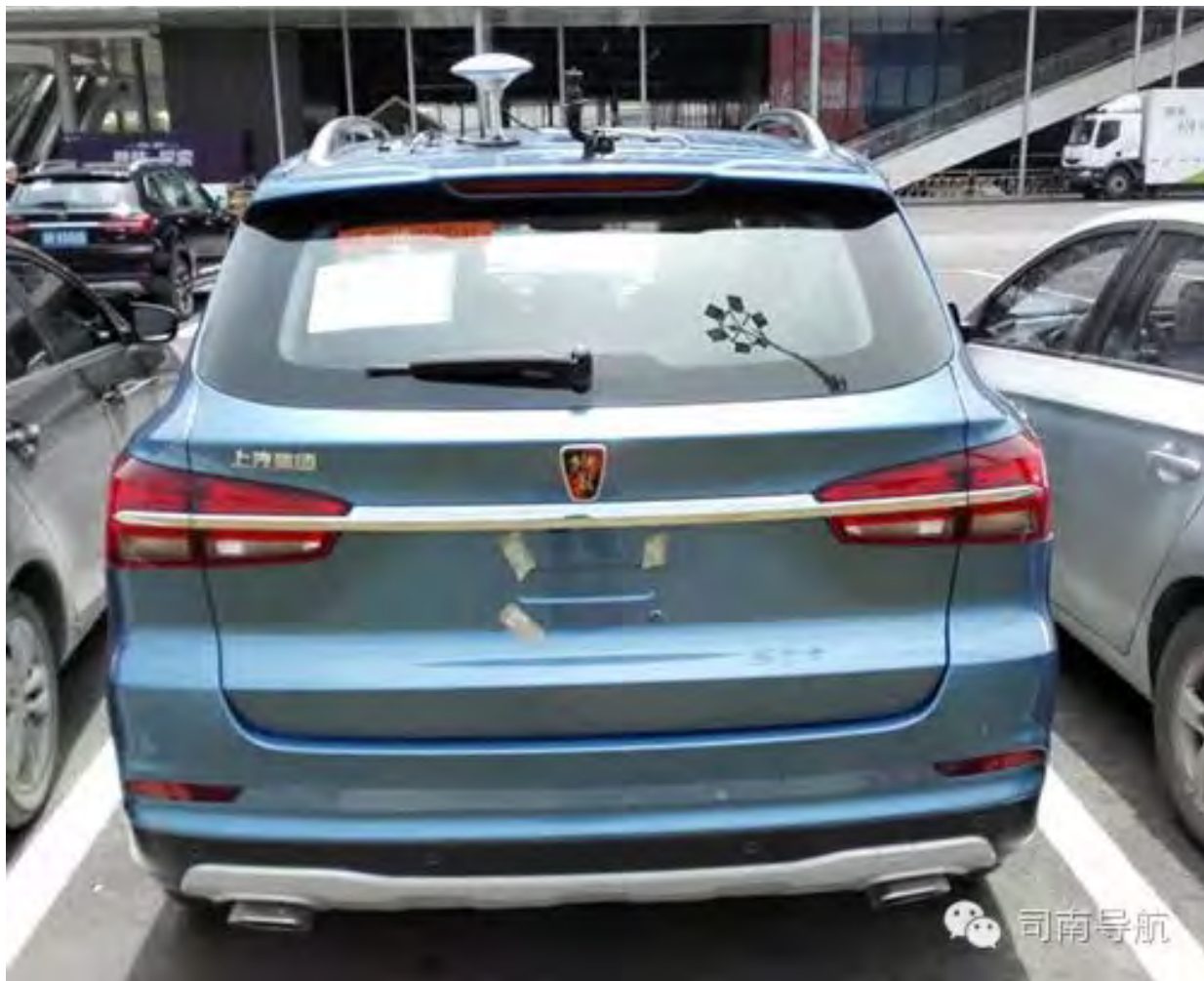
用来测试的工程车可以看到安装在车顶的GNSS天线
