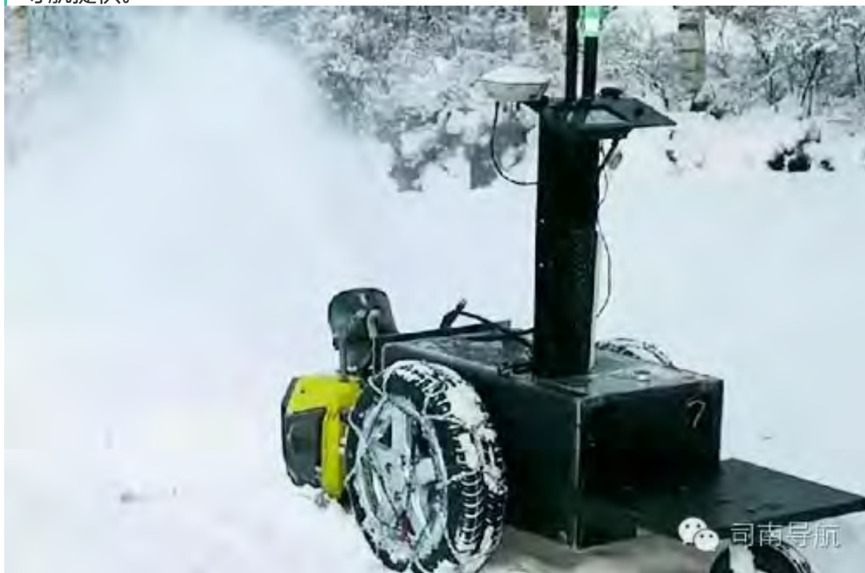
安装了司南导航T300接收机的机器人在进行扫雪
